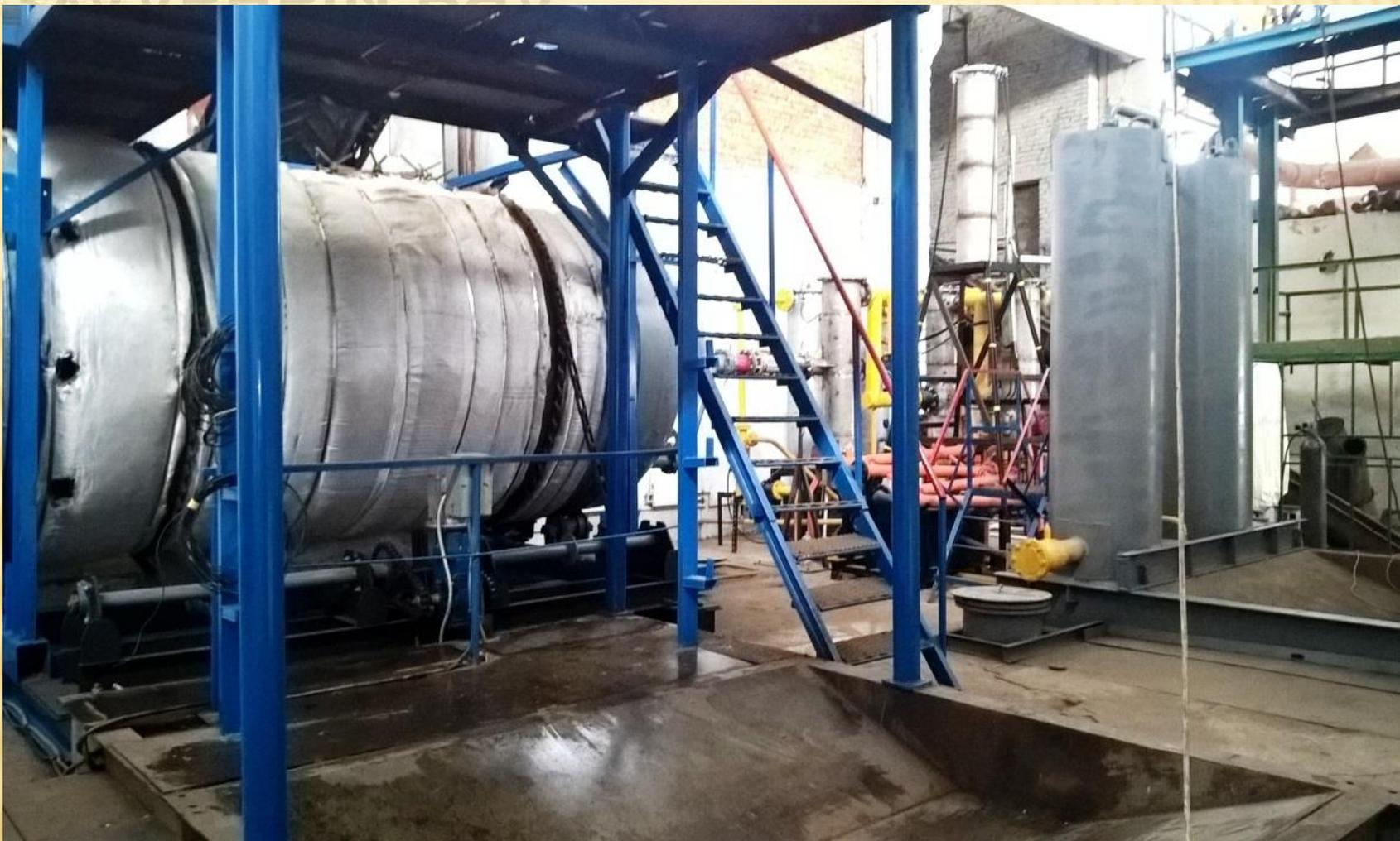
Пиролизный модуль ЭКУОТ в составе пиролизного аппарата, блока конденсации парогазовой смеси и АСУ
